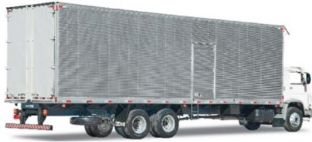
La caja de carga del furgón general se caracteriza por ser cerrada y del tipo baul. El acceso es hecho a través de las puertas traseras de apertura total en dos hojas, o por la lateral (opcional), a través de puertas simples y/ o doble en uno o más puntos, tanto al lado derecho como al lado izquierdo.
